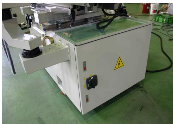
CE 規範電氣箱+電氣箱內部恆溫控制
