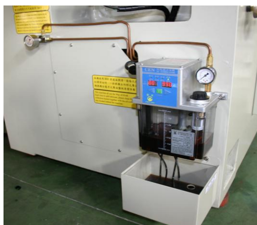
自動注油設備+手動注油孔
